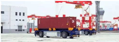
洋山四期 | 电动港作设备 锂电AGV配套自动换电，与电动桥吊、轨道吊协同作业。
